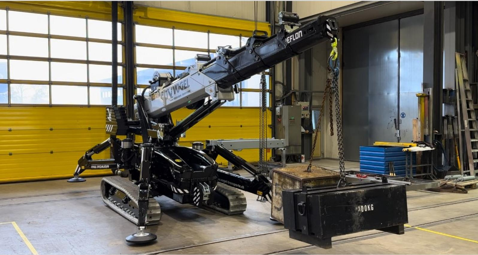
**Verstellbares Fahrwerk für Einsätze in seitlicher Schiefelage...**
